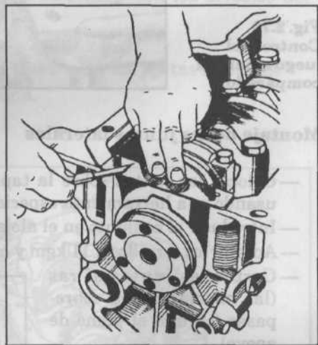
Fig. 2.73 Cortado de las juntas al ras.
