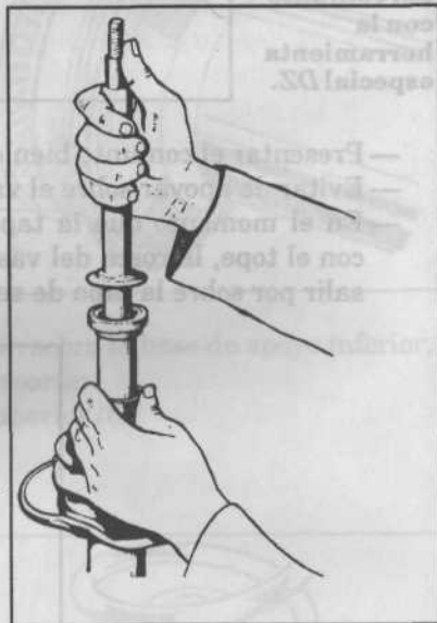
Fig. 9.9 Desmontaje del amortiguador. Extracción del mecanismo de adentro del cilindro.
