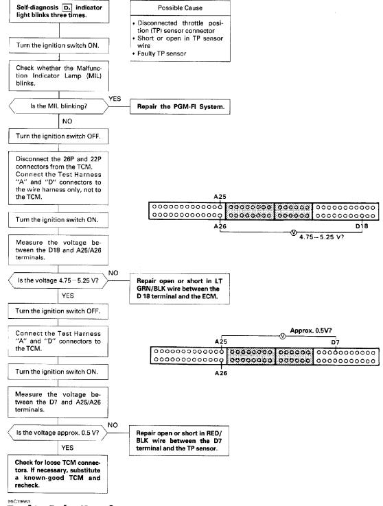
Fig. 37: Fault Code No. 3
