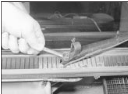
16.3 Slackening the wiper arm nut
