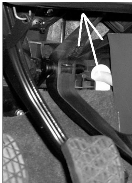
poi utilizzato dalla centralina ECU del cambio automatico per stabilire il corretto punto di passaggio da un rapporto all'altro e l'inserimento del kick-down.
