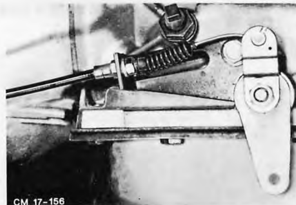
Fig. 33. Fit downshift cable
