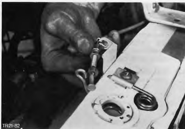
Fig. 16. Unhook hood cable
