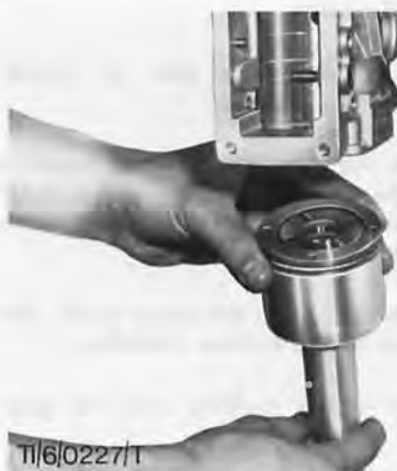
Fig. 26. Remove the vane pump
