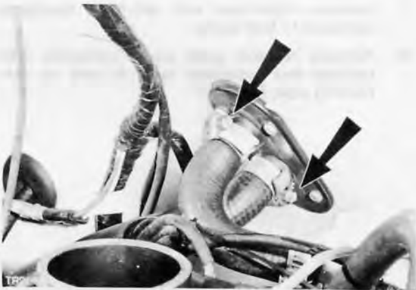
Fig. 20. Remove heater hoses
