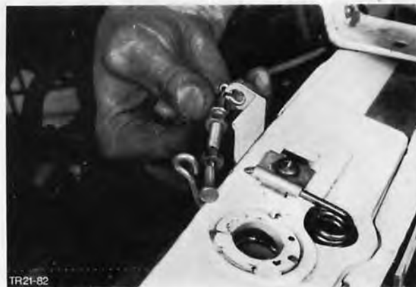
Fig. 141. Unhook hood cable
