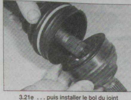
3.21e ... puis installer le bol du joint homocinétique extérieur en veillant à bien l'ancrer sur le jonc d'arrêt ...
