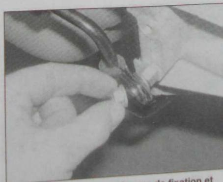
7.10a Desserrer les écrous de fixation et dégager les brides de maintien de canalisation de circuit d'assistance de direction à l'avant...
