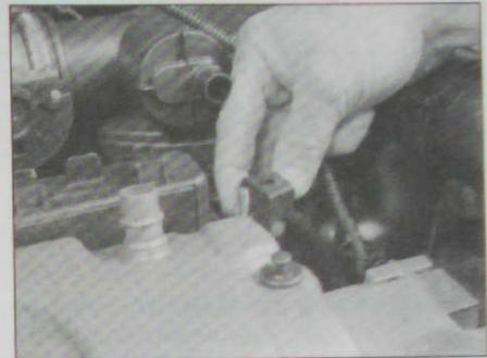
3.9 Dépose de la patte-support de tuyauterie côté G. du bloc des bobines
