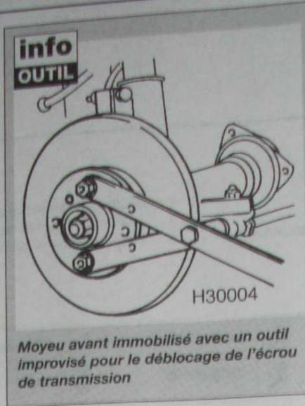
Moyeu avant immobilisé avec un outil improvisé pour le déblocage de l'écrou de transmission
