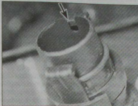
2.20 Cran de positionnement d'embout mâle de durit à disposition en bas
