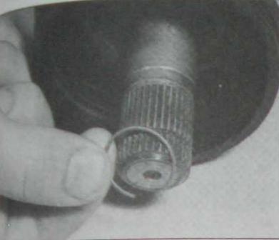
3.21d Monter le jonc d'arrêt dans la rainure sur l'arbre de transmission ...
