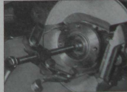
11.8 Dépose d'un moyeu AR. avec un extracteur deux griffes
