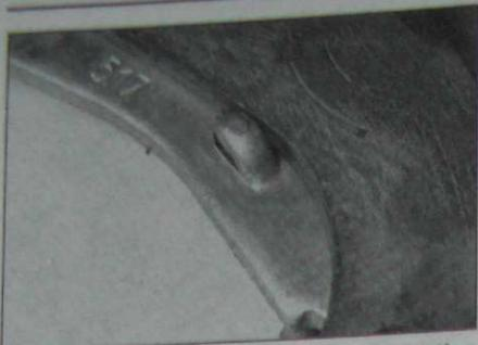
9.14 L'ergot de butée de la biellette de réaction de frein à main doit se trouver en appui sur le bord du segment tendu
