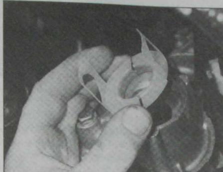
4.10a Monter la bague d'étanchéité neuve
