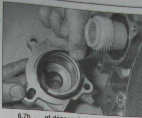
6.7b ... et dégager le boîtier de prise d'entraînement du compteur de vitesse, en récupérant le joint torique (vue avec boîte déposée)
