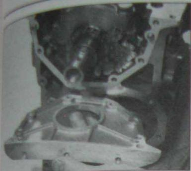
12.4 Dépose du flasque d'étanchéité D. du vilebrequin
