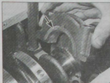
12.7 Dépose du chapeau de palier n° 2 de vilebrequin. Demi-cale de butée axiale fléchée
