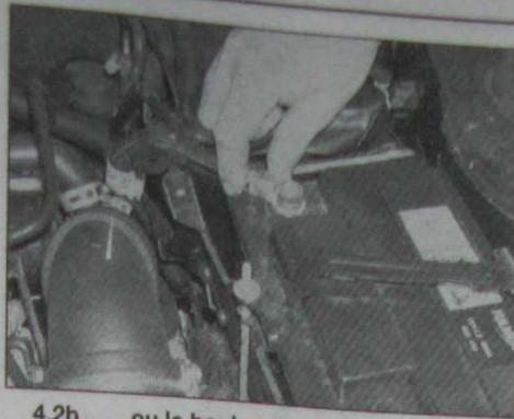
4.2b ... ou le boulon du collier de la cosse pour débrancher le câble de masse (-) de la batterie
