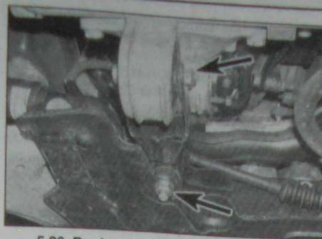
5.26 Boulons de fixation de la biellette antibasculement du support AR. du groupe motopropulseur
