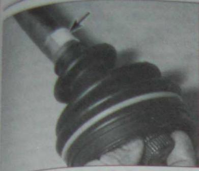
3.21b ... puis installer la bague d'appui en plastique dans la gorge sur l'arbre de transmission ...
