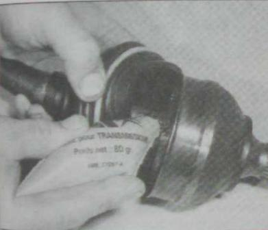
3.21f ... et bourrer le joint homocinétique et le soufflet de la graisse fournie avec le nécessaire, en veillant à bien la répartir sur les chemins de roulement des billes tout en faisant jouer le joint
