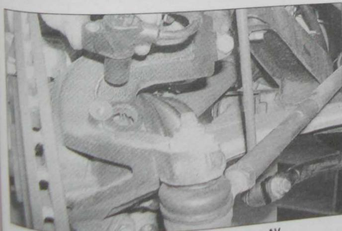
24.20b ... et dépose d'un capteur de roue AV.
