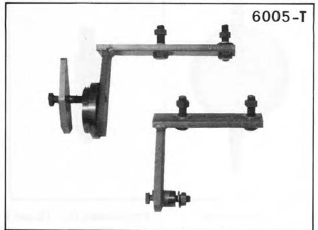
Adaptación para montaje del motor sobre el caballete 2509-T
