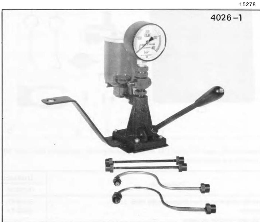
Conjunto bomba y tuberías de unión para tarado de los inyectores
