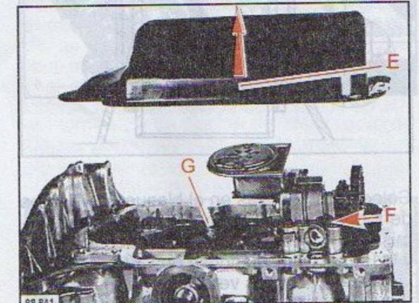
Dar la vuelta al motor y retirar los diecinueve tornillos de fijación del cárter de aceite y el cárter de aceite (E).
