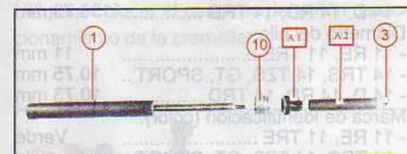
Preparar el cartucho de amortiguador (11), el tapón (10), la llave de tetones A1, el separador A2 y la tuerca (3).
