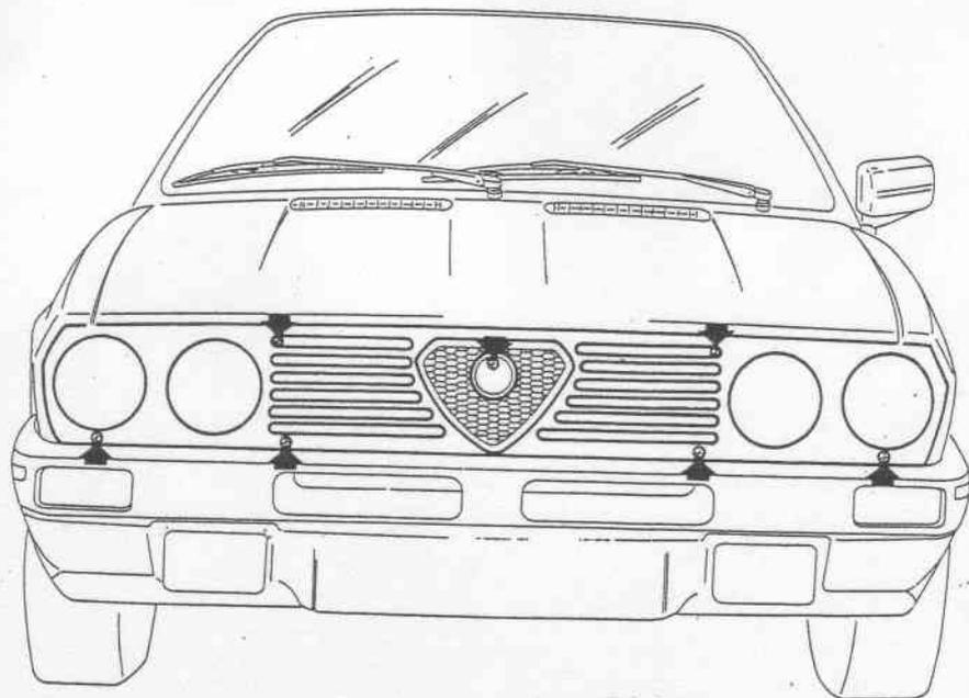
4. Die obere Befestigungsmutter des Kühlergrills (1) am seitlichen Haltebügel abschrauben. Kühlergrill ausbauen.
