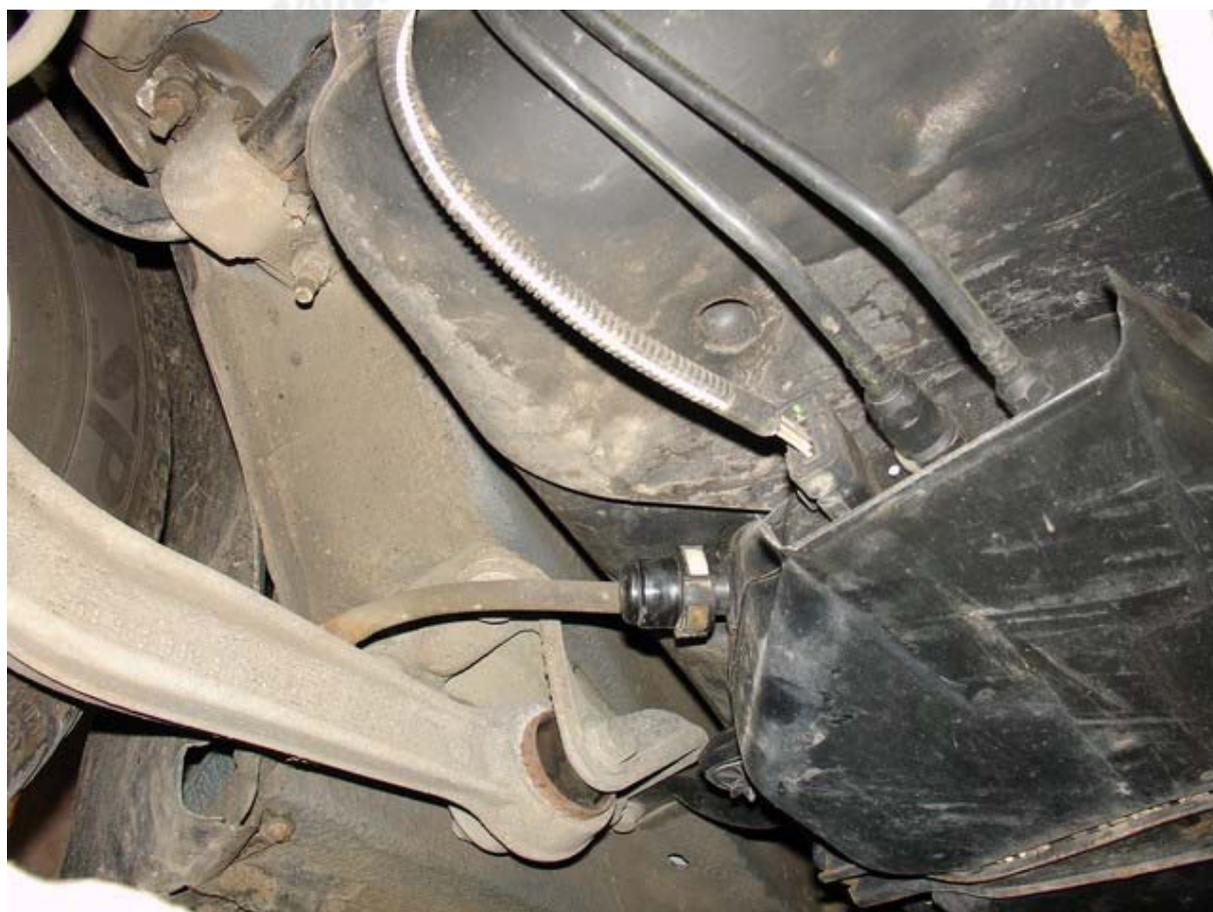
Déposer le bouchon de trop plein du réservoir d'additif (2).
