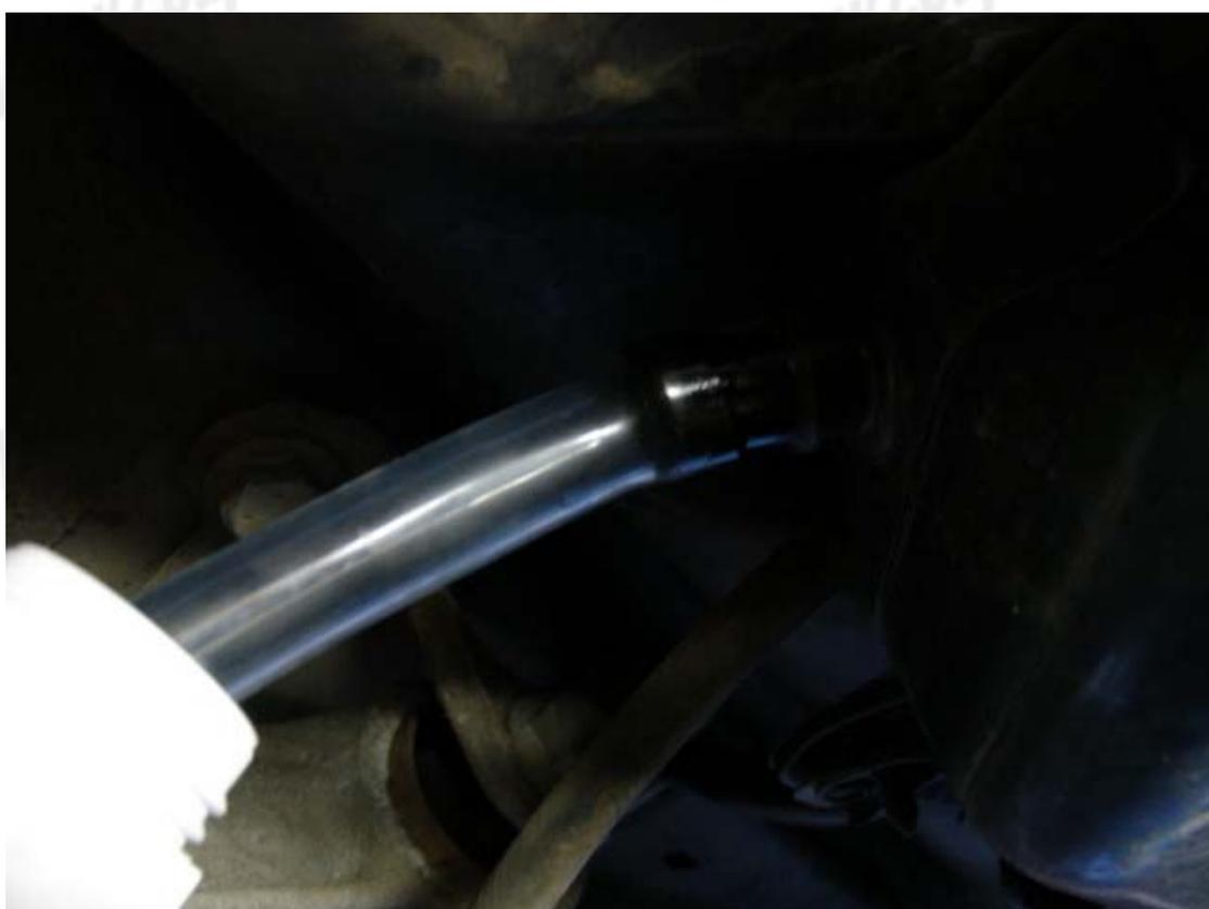
Brancher le tuyau du récipient de récupération (3) sur le trop plein du réservoir d'additif.
