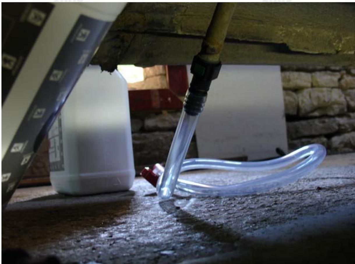
Suspendre le récipient d'additif à un niveau supérieur à celui du réservoir d'additif.
