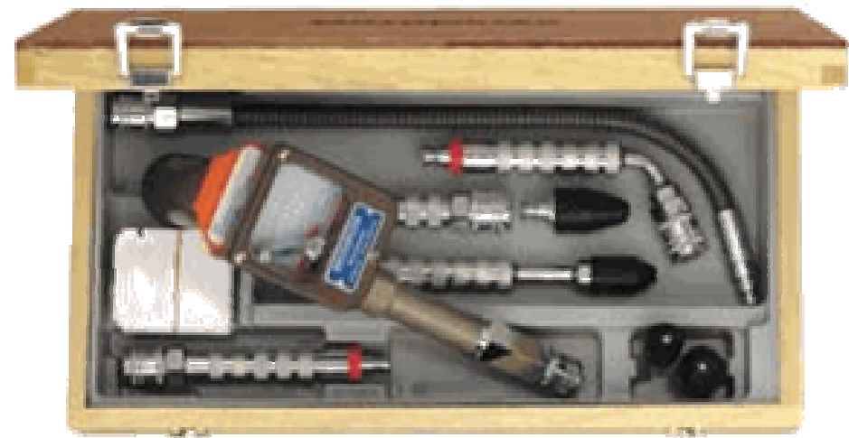
Coffret d'un compressiomètre enregistreur "Moto-Meter"
